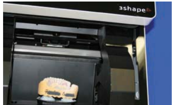
Abb. 4a und 4b: Die Aufstellung wird in einem Laborscanner (offener Datenexport) gescannt. Zuvor wurde bereits das Situationsmodell (ohne Aufstellung) in ein digitales Format umgewandelt.
